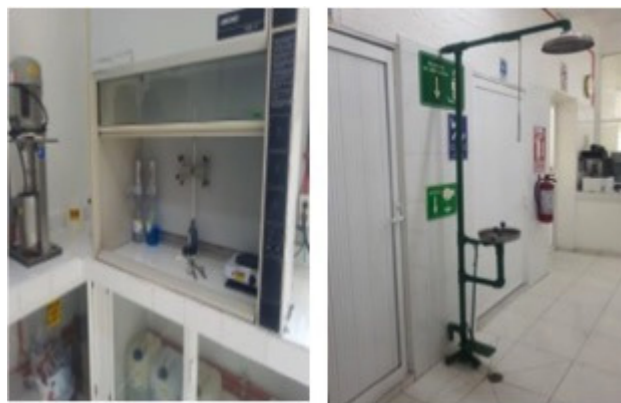
Campana para preparación reactivos/ regadera, lava ojos y extintor
